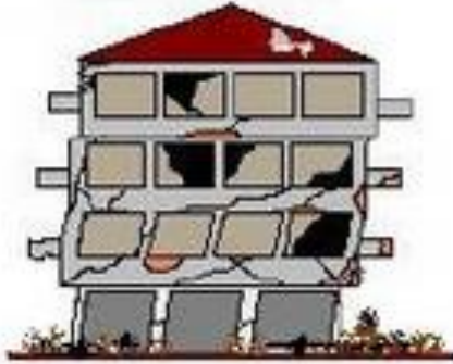
genel taşıyıcı hasarı
