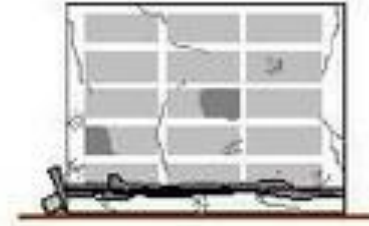
zemin kat çökmesi
